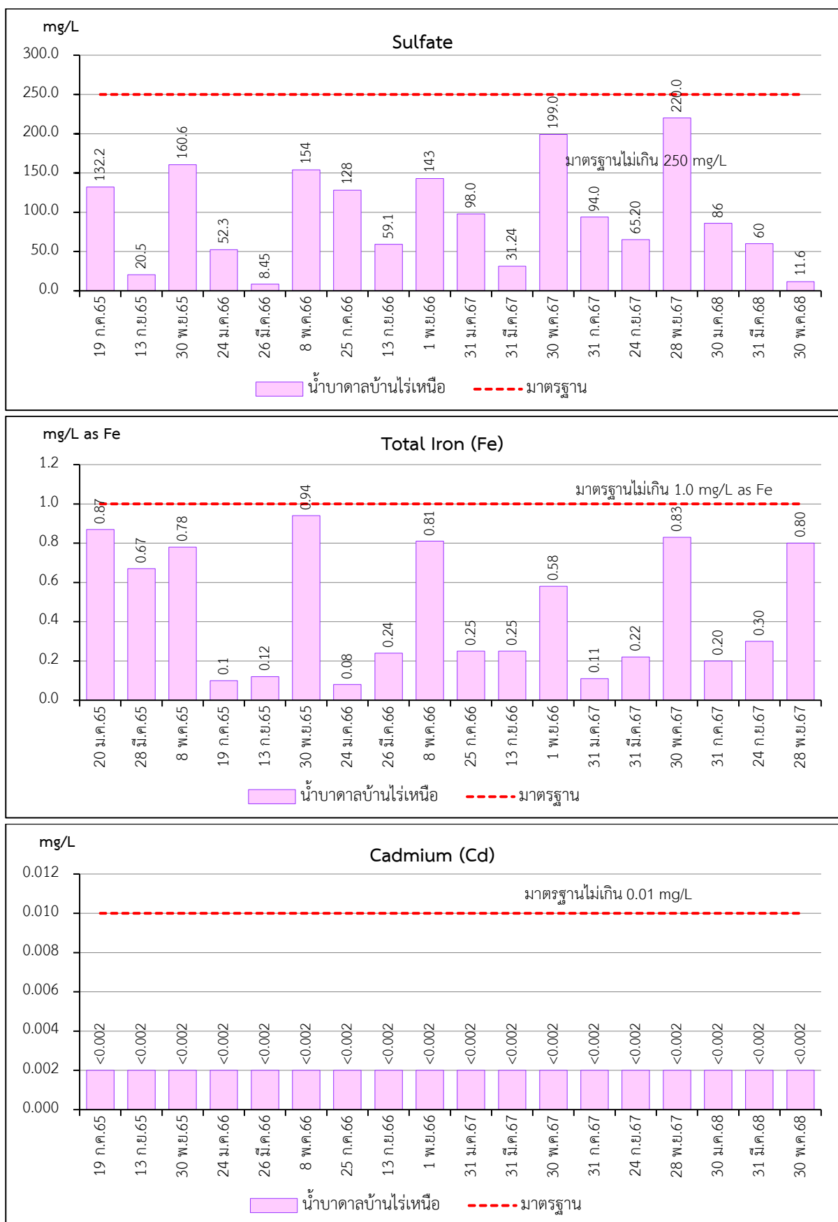
รูปที่ 3-6 (ต่อ) กราฟเปรียบเทียบผลการตรวจวิเคราะห์คุณภาพน้ำใต้ดินในช่วงที่ผ่านมาถึงปัจจุบัน
